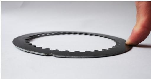
Poser le disque sur une surface plane, appuyez sur l'extérieur du disque, d'un côté ou de l'autre, il doit se redresser d'au moins 2,5/3 mm.
